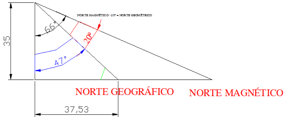
Figura 3.11 – Posição do Norte Geográfico e Norte Magnético
