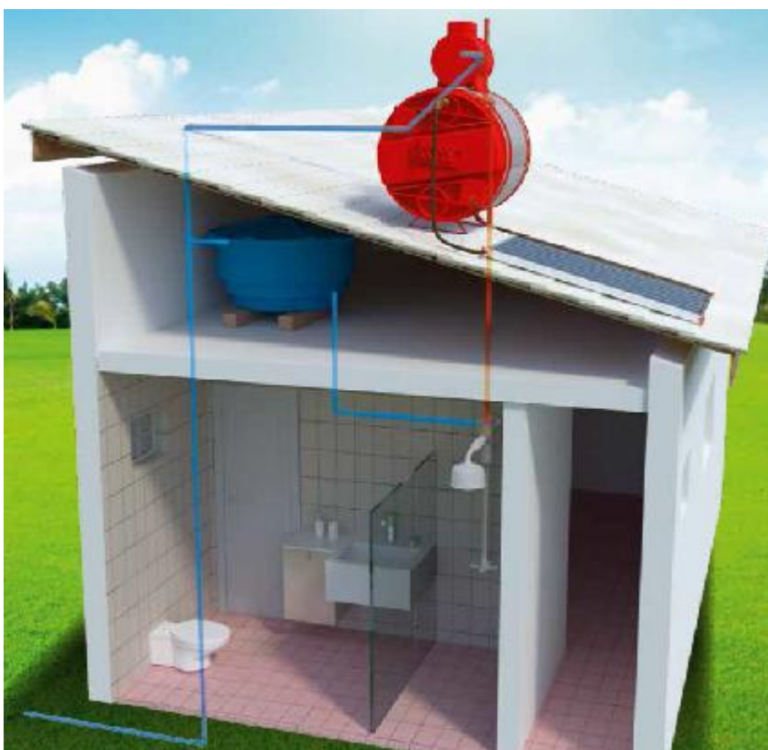
Figura 2.3 – Sistema de aquecimento por energia solar
